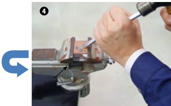
[加熱テスト後 タガネで叩きショック剥離テスト]
