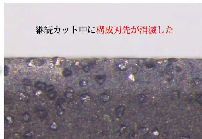
【音波金属接合】の精密技術の実績を基に 30 年間研究開発した結果、[構成刃先] が消える新工法を実用化しました。
