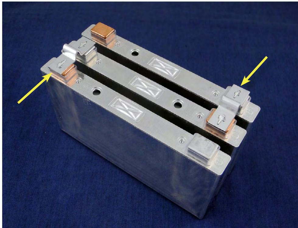
リチウムイオン電池セルのアルミバスバーとアルミ又は銅の端子による連結
