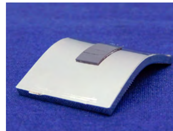
折り曲げて接合強度を確認
