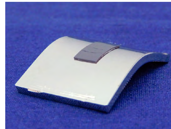
折り曲げて接合強度を確認
